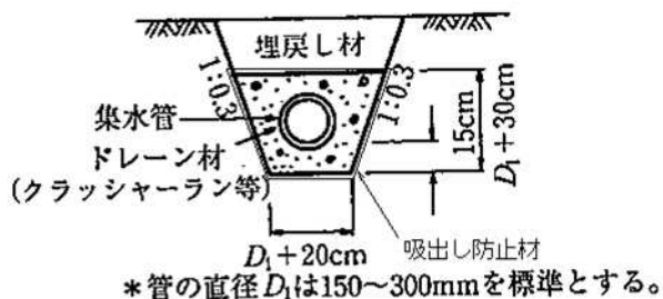
解図 9-2 地下排水工の構造例
