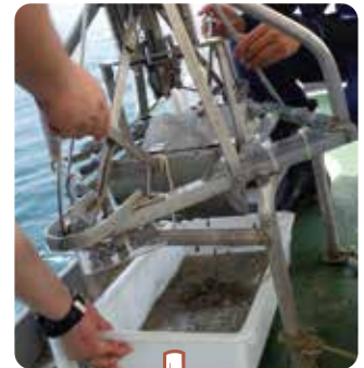
採泥器による海底土の採取
