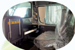
▲ 運転席等と後部座席がプレートで区切られた感染症患者搬送専用車
