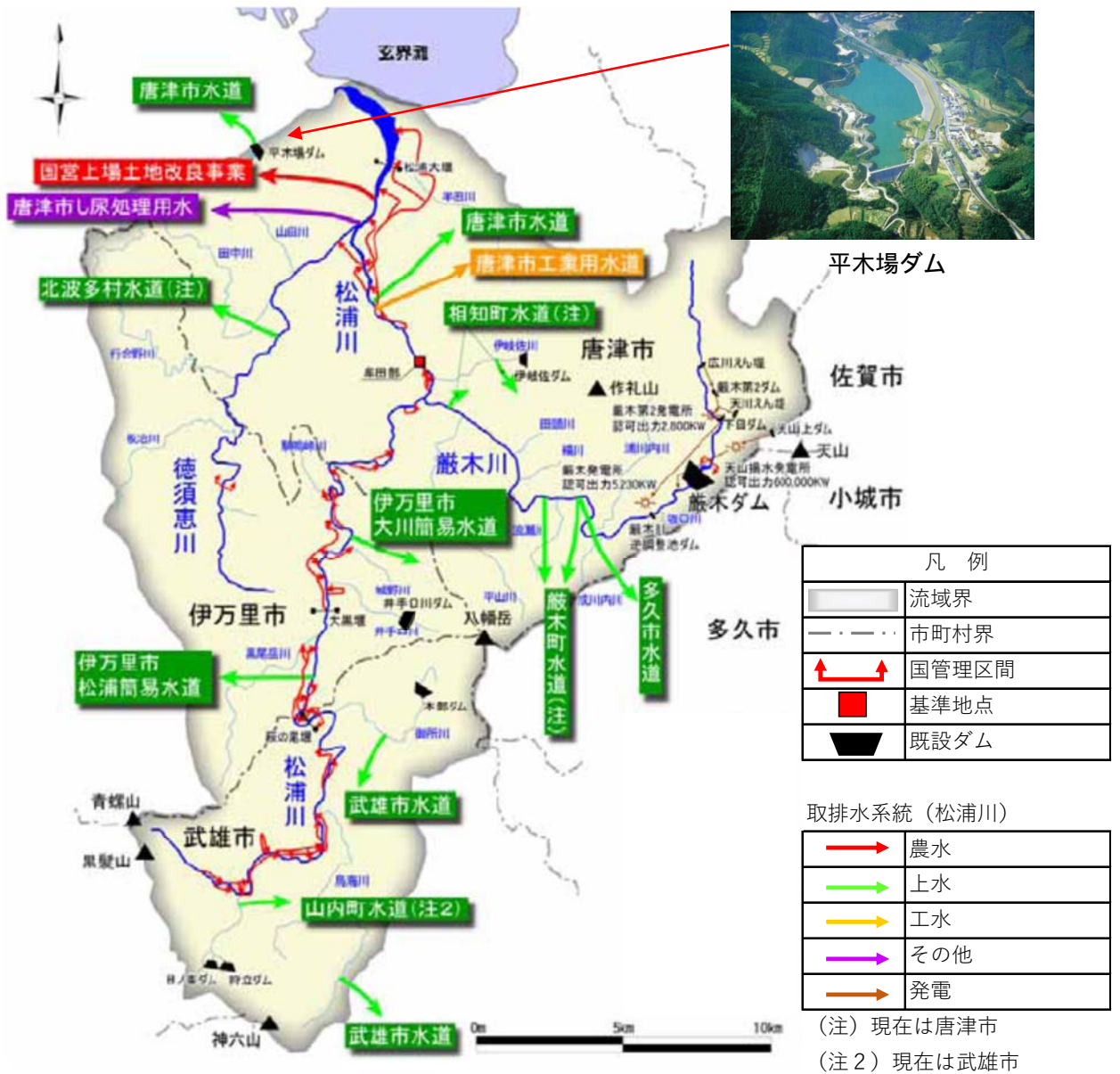
図 2.2.1 松浦川水系取水排水系統と主な利水施設
