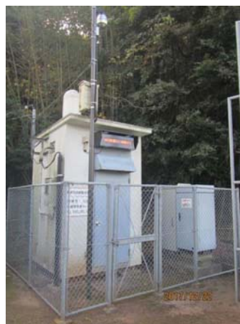
モニタリングポスト【石室局：唐津市】 空間線量率、気象データを測定
