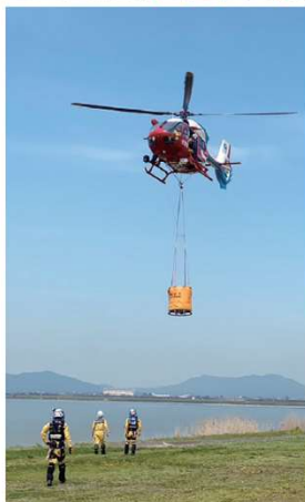
消火バケット
