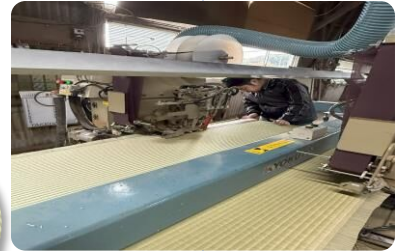
ソフトからのデータをもとに 厘単位 で幅を切断しながら、 縁を縫い付けていきます。
