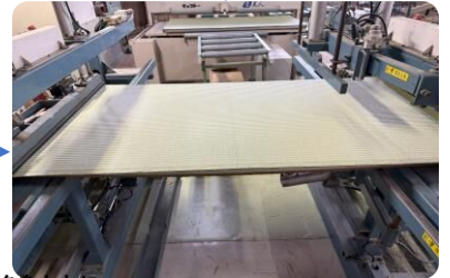
ソフトからのデータをもとに 厘単位 で幅を切断しながら、 縁を縫い付けていきます。
