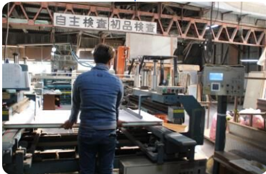
寸法割付ソフト を用いて、お部屋 の歪みに合わせて厘単位で土台を カットしていきます。 この細かい調整によって 隙間なく 畳を納めることができます。
