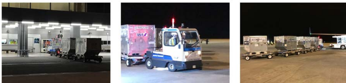
図 2-59 トーイングトラクター自動走行の実証実験（九州佐賀国際空港）
