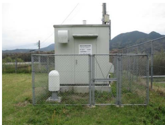
モニタリングポスト【松浦局：伊万里市】 空間線量率、気象データを測定
