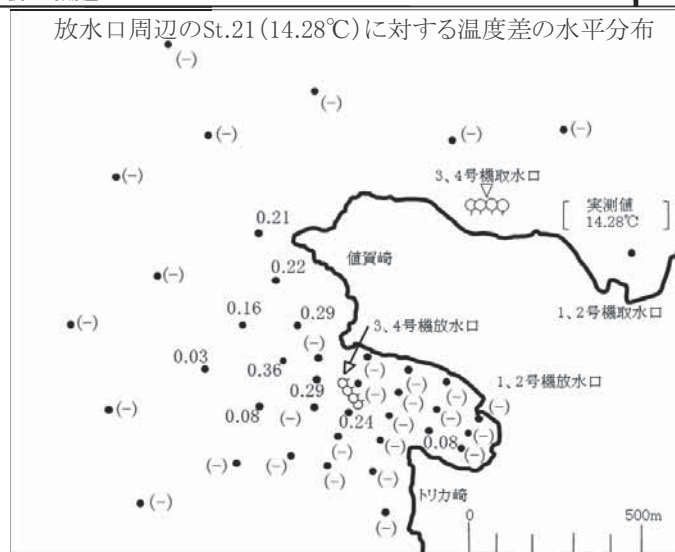
図2-3 冬季調査の下げ潮時における水深1m層の水温分布(上段)および放水口周辺の水温差分布(下段)
