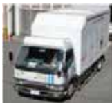
高圧発電機車
