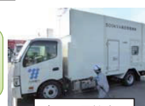
高圧発電機車
