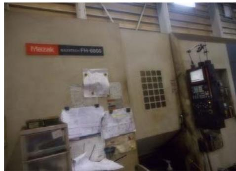
NC複合旋盤による、大型ミル加工が加工です。マシニングセンターによる三次元加工が可能です。CNC複合旋盤6軸制御による多品種他工程小ロットのワークを高速加工し、C軸・Y軸・B軸による、複雑な加工が可能です。
