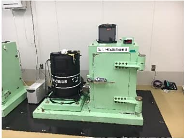
ゲルマニウム半導体検出器（γ線） ガンマ線の測定全般に使用
