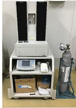
低バックグラウンド 放射能測定装置（β線） ストロンチウム90 の測定に使用
