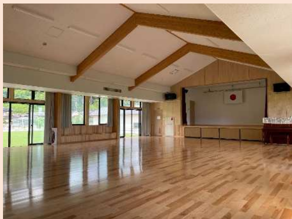
県産木材を活用して建てられた公民館（朝日公民館（武雄市））
