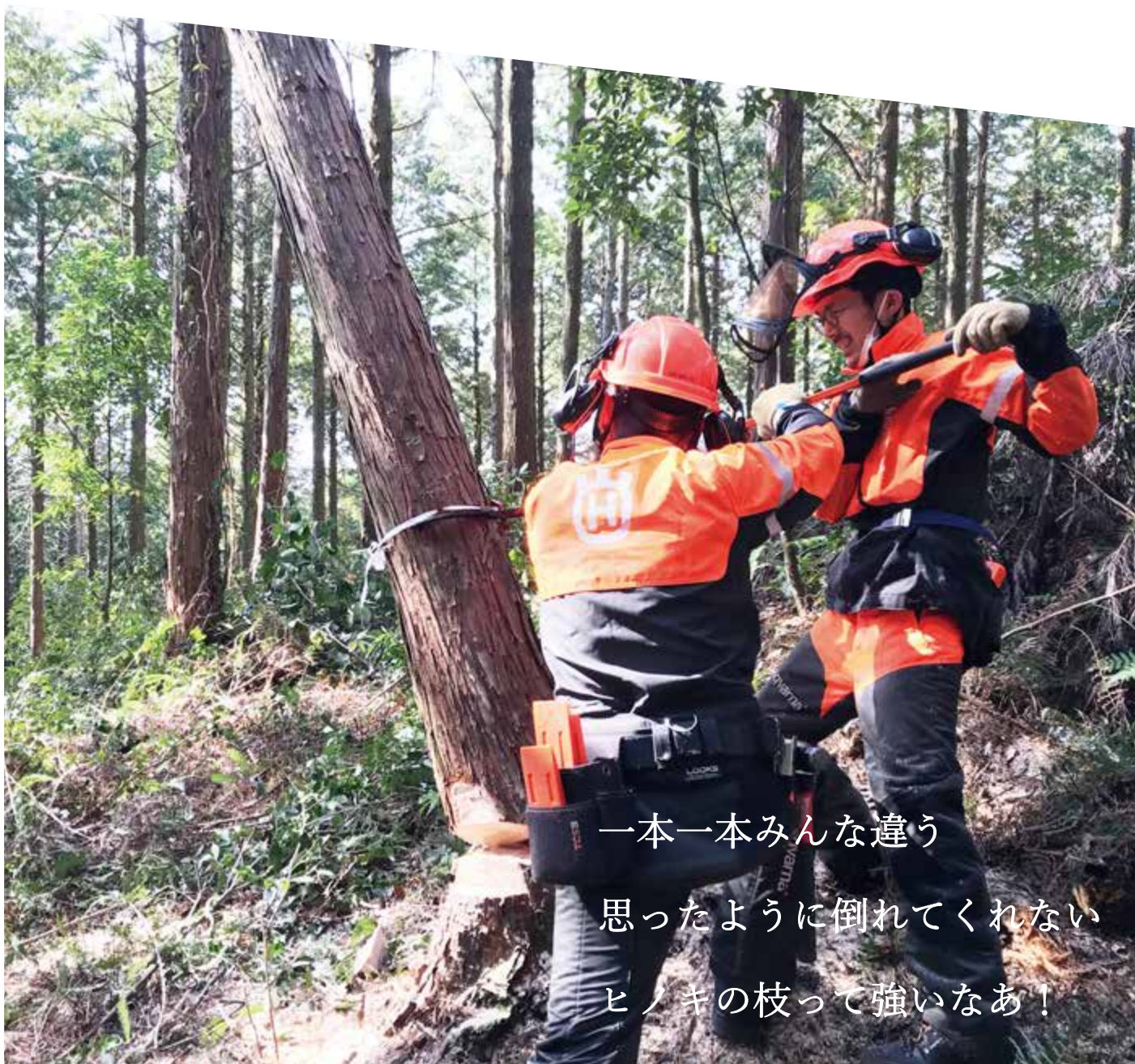
伐倒作業でかかり木処理に悪戦苦闘する受講生（さが林業アカデミー「林業講習会」での実習の様子）
