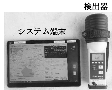
可搬型の走行サーベイシステム
